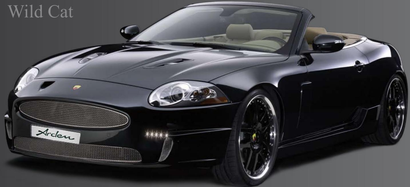
Die Front des Jaguar XKR wurde optisch durch spezielle, handgearbeitete und verchromte Edelstahlgitter aufgewertet und LED Tagfahrlichter integriert. Ein verändertes Motormanagement in Verbindung mit der Hochleistungsschalldämpferanlage ermöglichen eine Leistungssteigerung um 70 PS auf 580 PS und dazu passend wird eine V-Max Aufhebung und ein auf 320km/h erweiterter Tacho angeboten.
