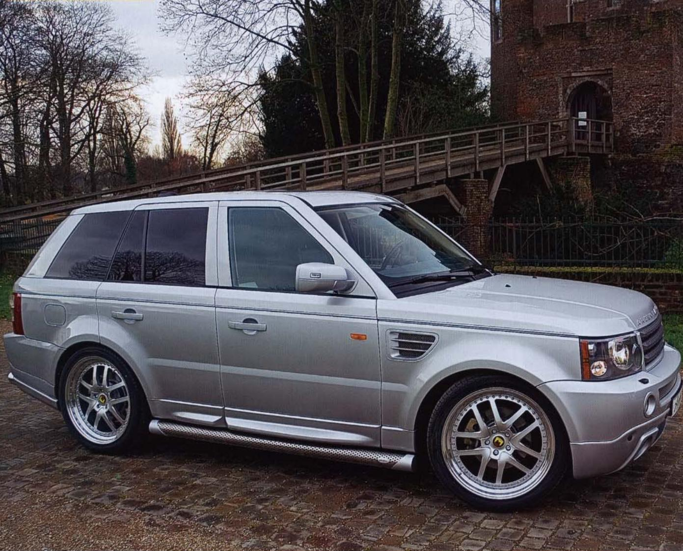
Отверстия в бампере и радиаторная решетка забраны аккуратной сеткой ручного плетения из нержавеющей стали. Такой же сеткой можно затянуть и вентиляционные отверстия в крыльях. Боковые накладки по низу дверей и задний бампер с имитацией гоночного диффузора замыкают нижний períметр кузова, делая его цельным и более красивым. Два
