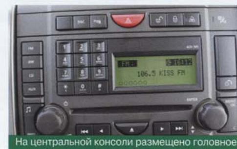
На центральной консоли размещено головное устройство аудиосистемы Harman/Kardon с системой обработки звука Logic 7
