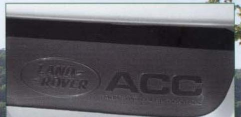
Радар системы активного круиз-контроля (ACC) встроен в передний бампер
