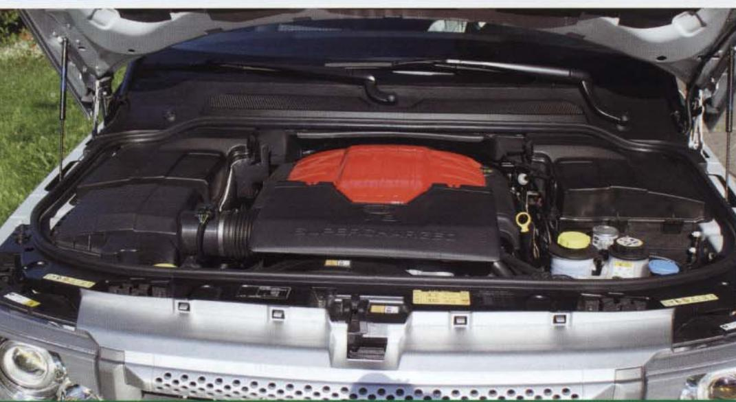
Под капотом тестируемого вседорожника – 4,2-литровый двигатель с механическим нагнетателем. Путем «перечиповки» электронного блока базовая мощность (390 л. с.) была поднята на 40 «лошадок», до 430 л. с.
