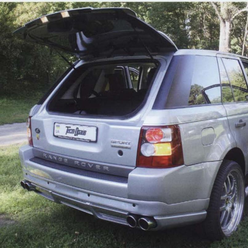
Для загрузки в багажник служит одностворчатая откидная дверь, сделанная целиком из алюминия. А для быстрого доступа в багажный отсек можно поднять только верхнюю часть двери – стеклянную
